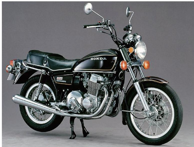
CB750 シリーズをベースに、クルマのシビックやアコードで実績を積んだ、ホンダマチック機構（2段変速オートマチック）をバイクに初めて搭載。1977年。
