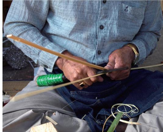
ナタ（包丁）の刃と背を使って荒くへちている（ひごの元材料を作る）ところ。この作業を「へちる」と呼ぶ。削り用のナタもある。
